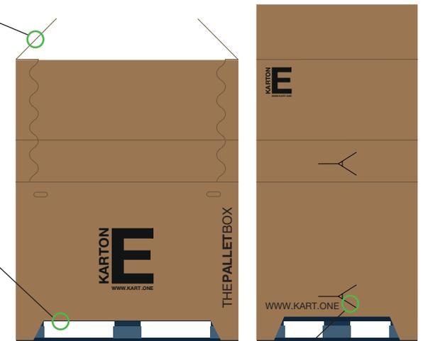
Die THEPALLETBOX hat eine **patentierte Fixierungsvorrichtung** in Y-Form an der rechten Seite und der Rückseite des Paletten-Containers. Eine kurz über dem Boden, eine weitere auf halber Höhe über der Ladeklappe.
